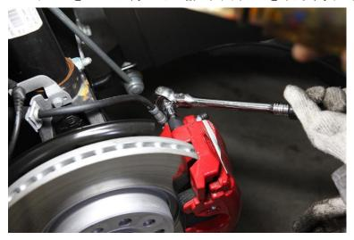
4. キャリパーを外した後、ローターの上に乗せ、ブレーキパッドを外します。
